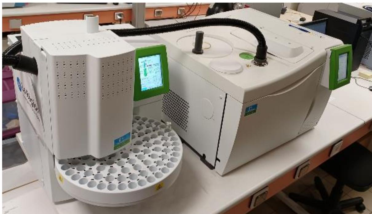
Photo d'illustration 1 : Headspace Turbomatrix couplé à un GC-FID
